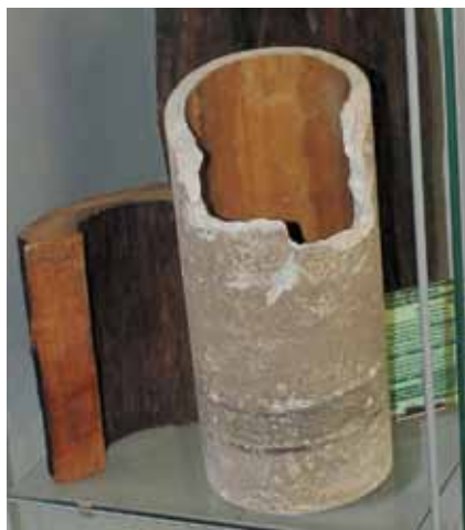
Ekspozycja średniowiecznych drewnianych rur wodociągowych wyżłobionych z pni drzew.
